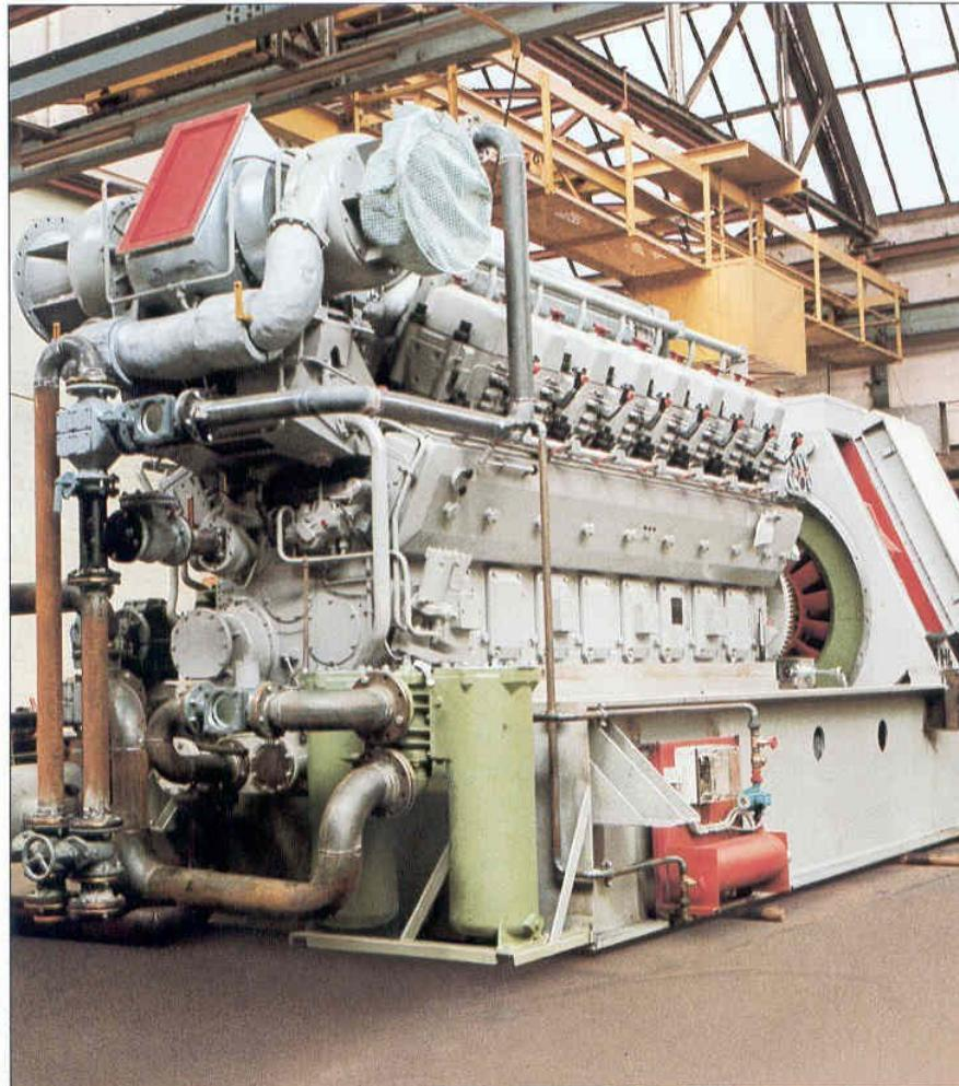
装于钢焊接底座上的中速机组
